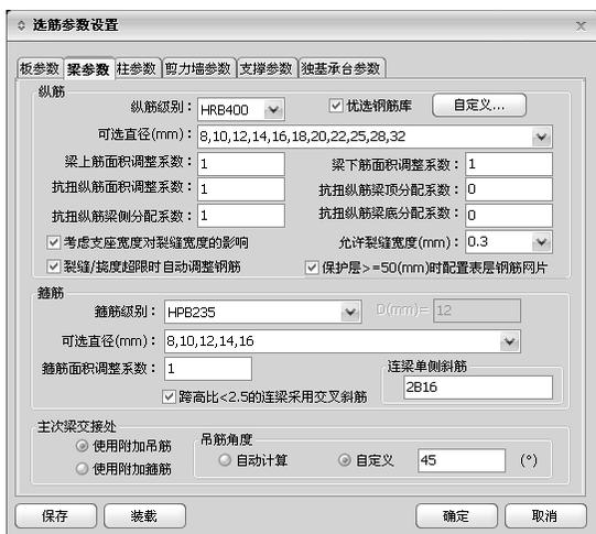
图 3.4.3-1 选筋参数设置 (梁参数)
