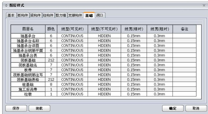
图 8.1-11 图层样式—基础
