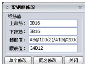
图 5.3.4 梁钢筋修改
