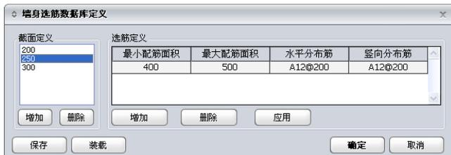
图 3.4.8-11 墙选筋定义
