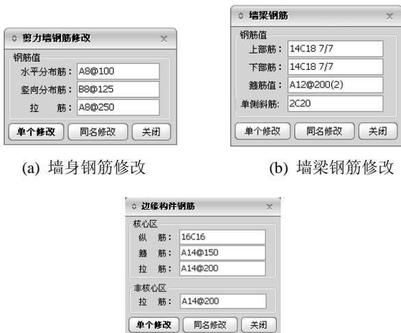
图 5.5.6 剪力墙钢筋修改
