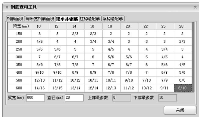
图 9.1-3 钢筋查询表（梁单排钢筋）
