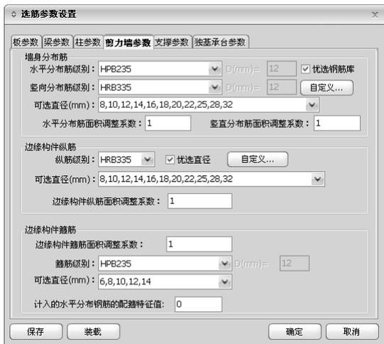
图 3.4.5 选筋参数设置（剪力墙参数）
