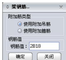
图 5.3.3-2 修改次梁吊筋
