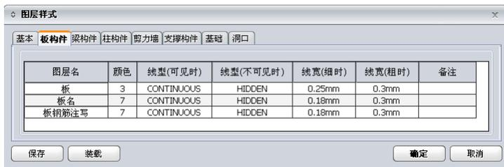
图 8.1-6 图层样式—板构件
