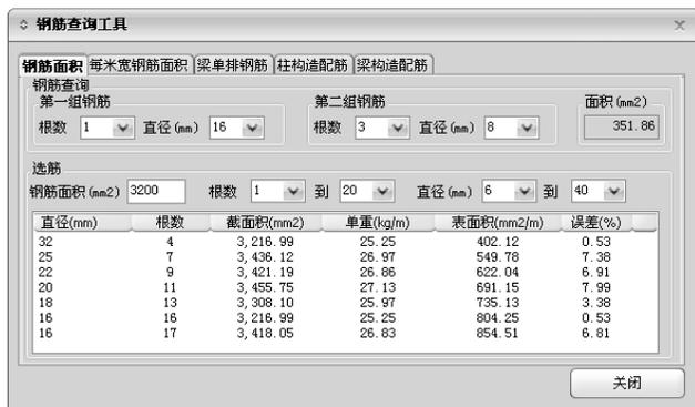
图 9.1-1 钢筋查询表（钢筋面积）
