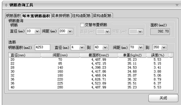
图 9.1-2 钢筋查询表（每米宽钢筋面积）
