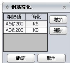
图 3.5-10 钢筋简化标注
