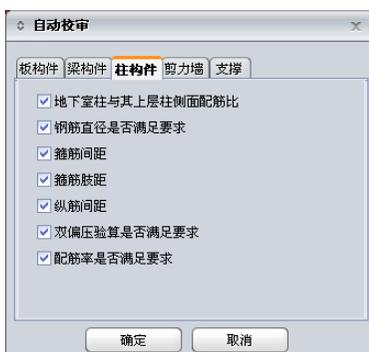
图 7.1-3 自动校审-柱构件
