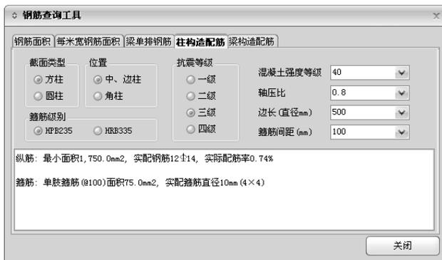
图 9.1-4 钢筋查询表（柱构造钢筋）
