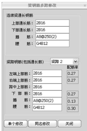
图 5.3.3-1 多跨梁钢筋修改
