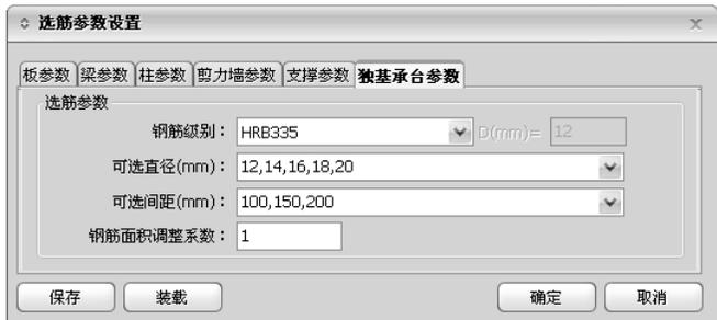
图 3.4.7 选筋参数设置（独基承台参数）
